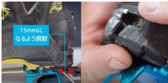
②ブーツサイズに合わせてセンターストラップの長さを調節します。
