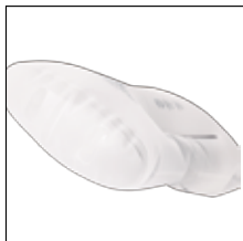
バックリングしやすい底の形状
