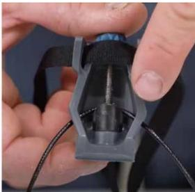
①ヒールレバーのネジを最大開放位置に調整します。
