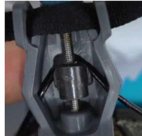
④ヒールレバーのネジを締め、センターストラップにテンションが強くなるよう調整します。
