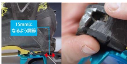
②ブーツサイズに合わせてセンターストラップの長さを調節します。 【重要】 クランボン後ろがブーツ後端より15mm手前になるよう調節します。
